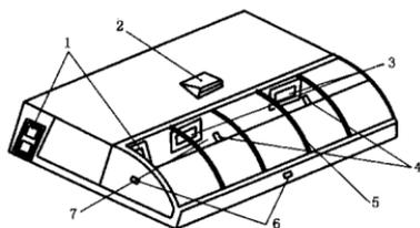
1—门;2—百页窗排气孔;3—隔墙玻璃窗;4—鸡出入孔;
