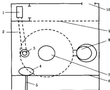
1—厕所;2—进料口暗道;3—进料口;4—集水槽;5—集水槽通道;6—前护栏;
