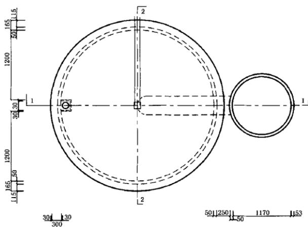
图 A1 8 m<sup>3</sup> 底层出料水压式沼气池俯视图
