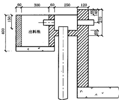
图 B3 沼气池出料池剖面图
