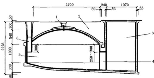
1—导气管;2—贮气箱;3—出料间(水压间);4—出料口通道;5—发酵间;6—进料管
