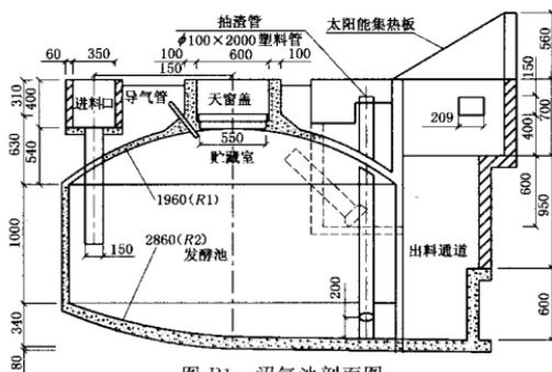
图 B1 沼气池剖面图
