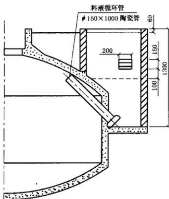
图 B2 沼气池液液循环管剖面图
