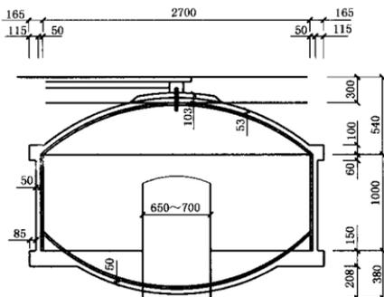
图 A3 8 m<sup>3</sup> 底层出料水压式沼气池剖面图
