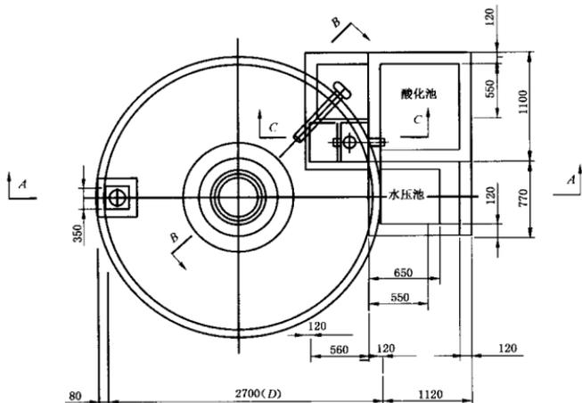
图 B4 沼气池平面图
