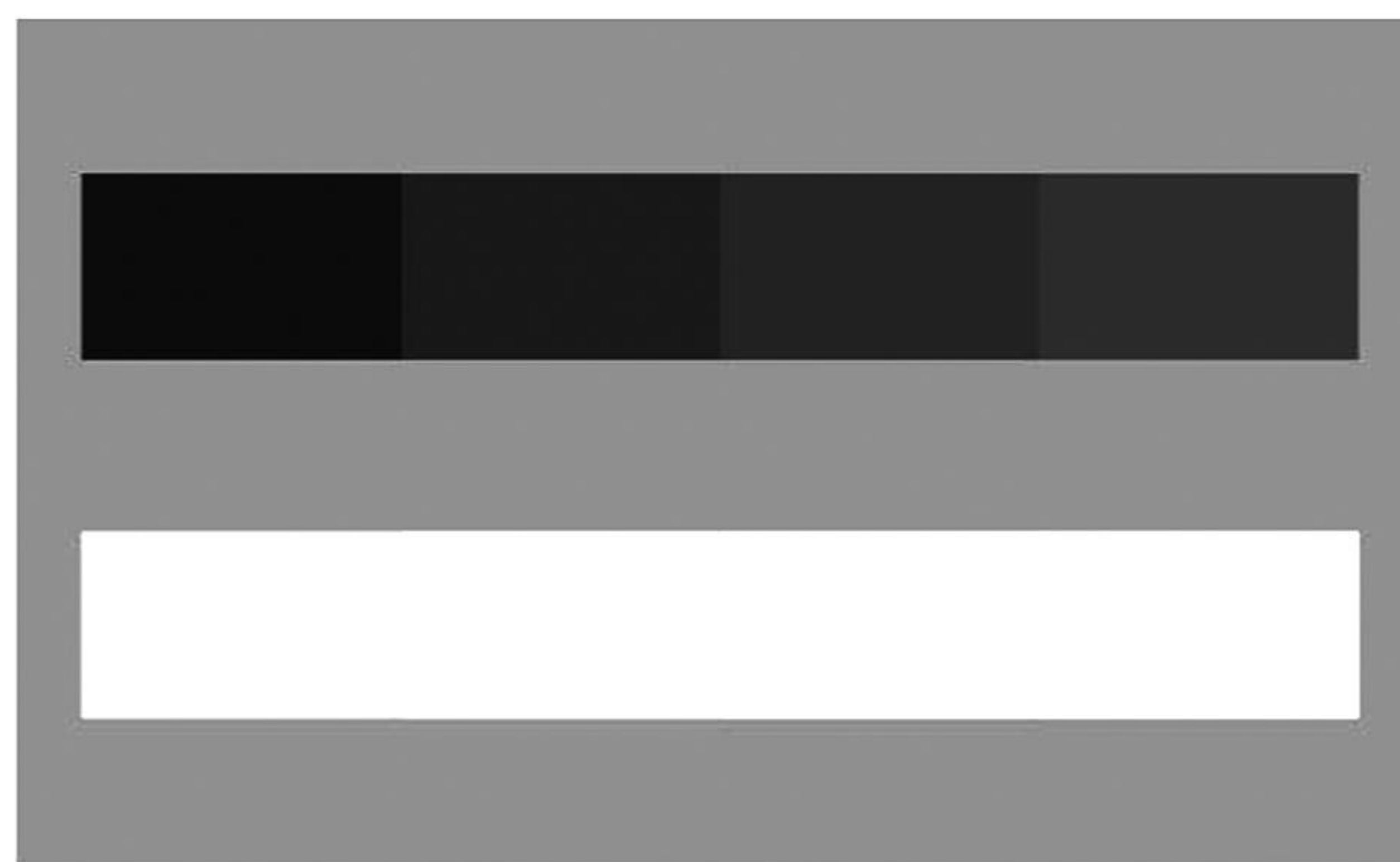
图 A.1 极限八灰度等级信号示意图
